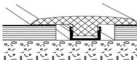
Las cubrejuntas transición son comúnmente utilizadas como uniones entre dos recintos que tengan una superficie instalada del mismo espesor. Este producto se instala muy fácil y rápido gracias al perfil de base clic con tornillos y tarugos que vienen incluidos al pack.
